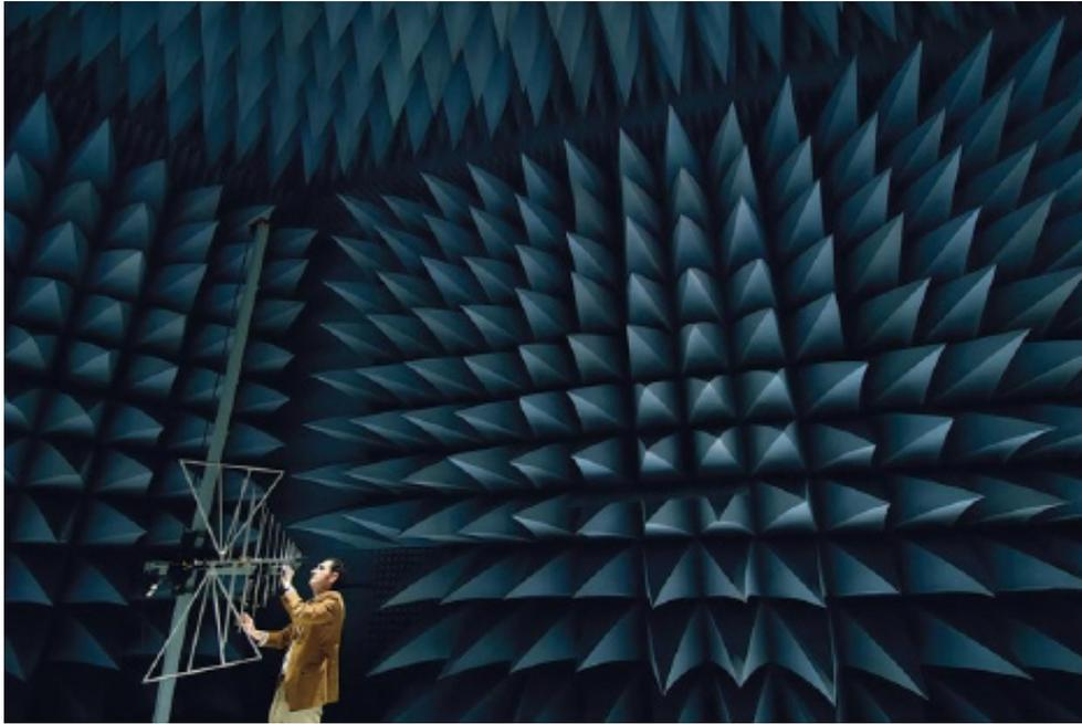
**Figura 1.** La cámara anecoica es capaz de evitar la totalidad de reflexiones producidas por ondas acústicas y electromagnéticas. Fotografía: Max Alexander / PromoMadrid licencia de uso Creative Commons.
